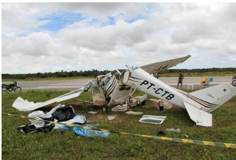
Figura 8 - Vista da aeronave com a cauda seccionada após colisão com o solo.
